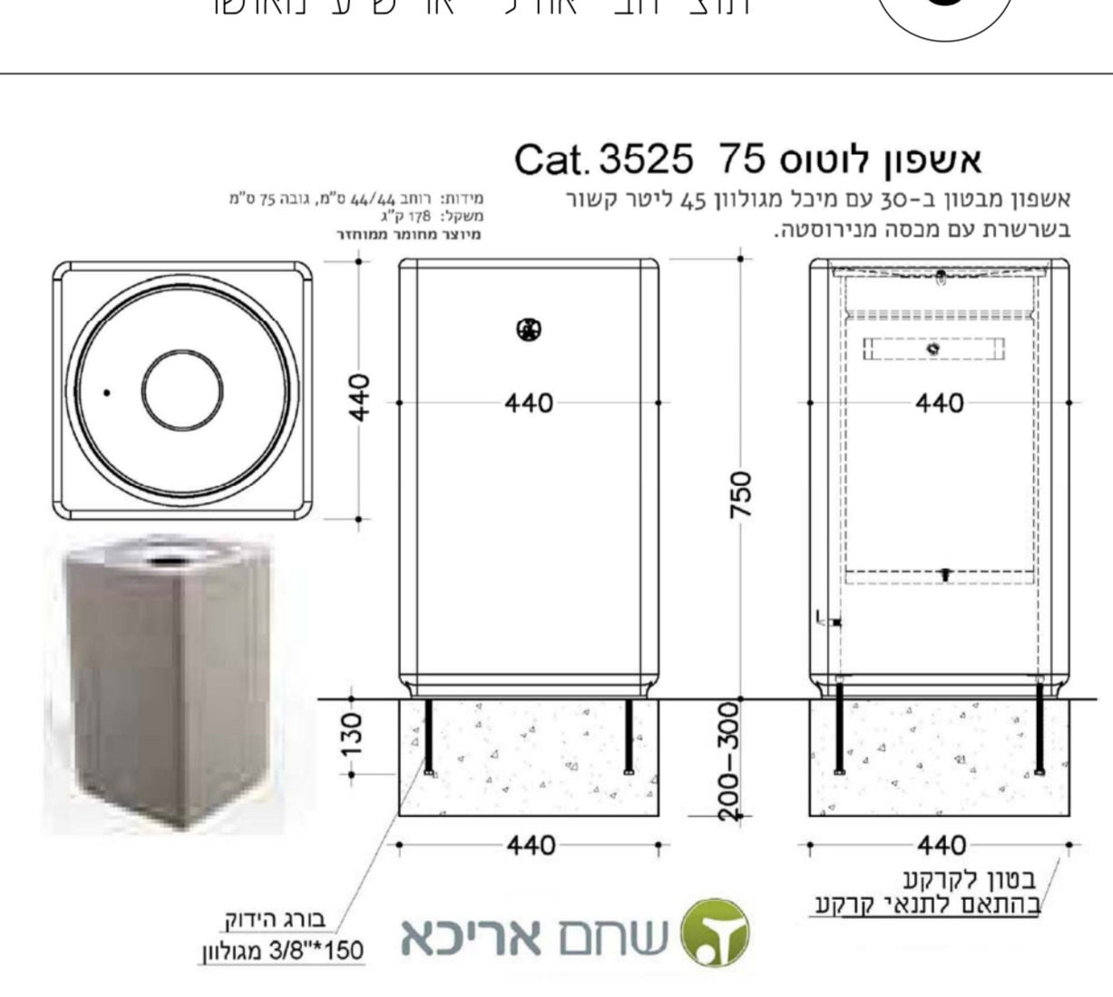
6 אשפון לוטוס 75 Cat. 3525 אשפון בטון ב-30 עם מיכל מגולוו 45 ליטר קשור בשרשרת עם מכסה מנירוסטה.
